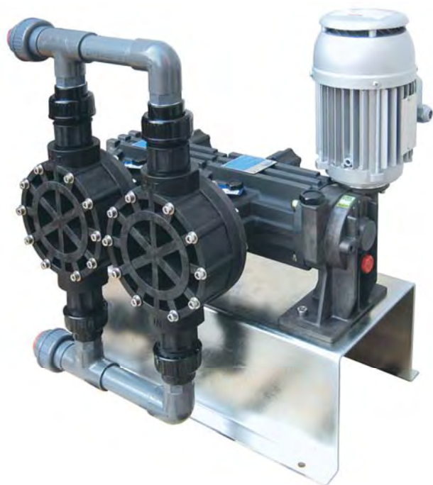
MC系列PP聚丙烯材质双泵头泵, 带有PVC管接头(1" BSP螺纹接口连接) 最大流量 840 l/h, 最大压力5 bar g。
